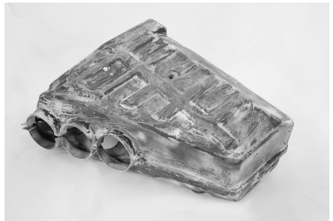
Nicht mehr erhältlicher Klimakanal für einen Oldtimer, der ersetzt werden musste.
