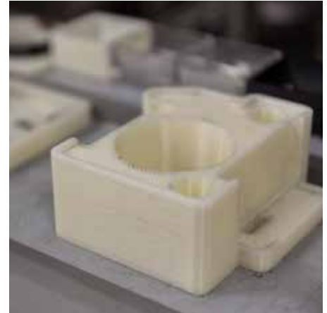
従来の治具は金属製で非常に重く、これを支えるために必然的に作業台も大きく重かったが、Fortus で造形した治具は従来の金属製の 20 分の 1 と圧倒的に軽いことで、まったく新しい発想の作業台を思いついた。
