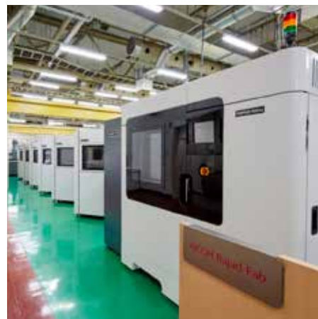
治具を製作する 3D プリンタとして力を発揮した Fortus。帯電防止効果を持つ造形材料や、高い強度を持つもの、耐熱性を持つものなど、用途に合わせた機能性材料をそろえている Fortus が最適と判断した。
