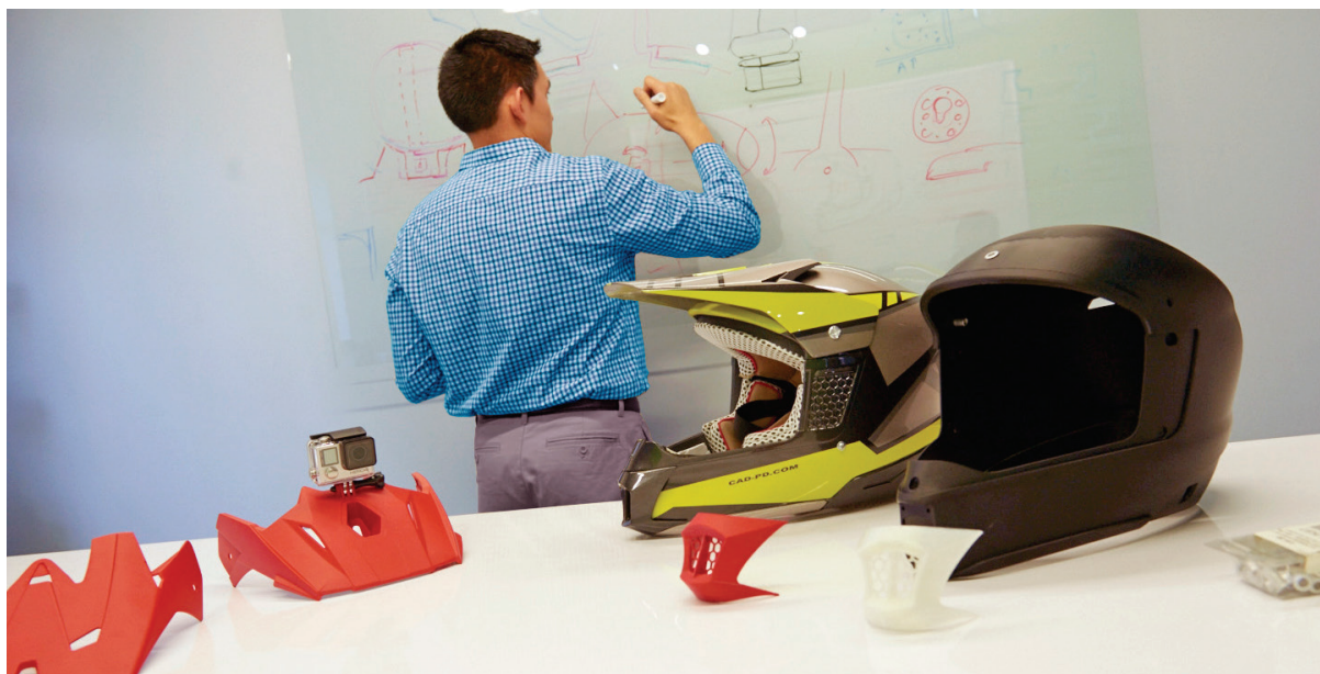
ヘルメット用カメラマウント、最終完成品のヘルメット、赤色と白色のマウスピース、CADによるヘルメットのプロトタイプ（左から右）
