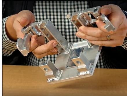
Le posage d'assemblage de gauche est composé de plusieurs pièces soudées et goupillées ensemble.
