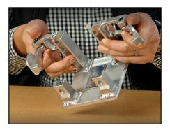
Die Montagevorrichtung auf der linken Seite besteht aus mehreren Bauteilen, die zusammengeschweißt und zusammengesteckt werden.
