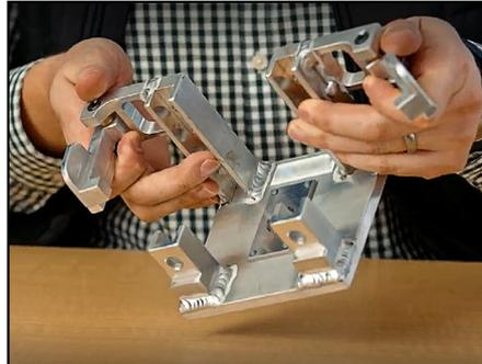
Il dispositivo di assemblaggio a sinistra è composto da più parti saldate e fissate insieme.
