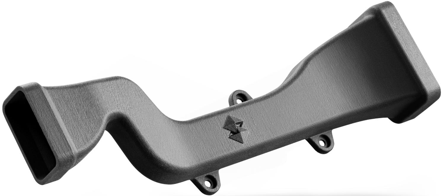
Ce conduit d'air fait partie d'un système de CVC automobile, imprimé avec la technologie SAF™. Par les techniques traditionnelles, une pièce comme celle-ci aurait été moulée en deux moitiés, puis assemblée. Avec la technologie SAF, les moitiés peuvent être produites en une seule pièce, réduisant ainsi l'assemblage en post-traitement et les risques de défaillance.
