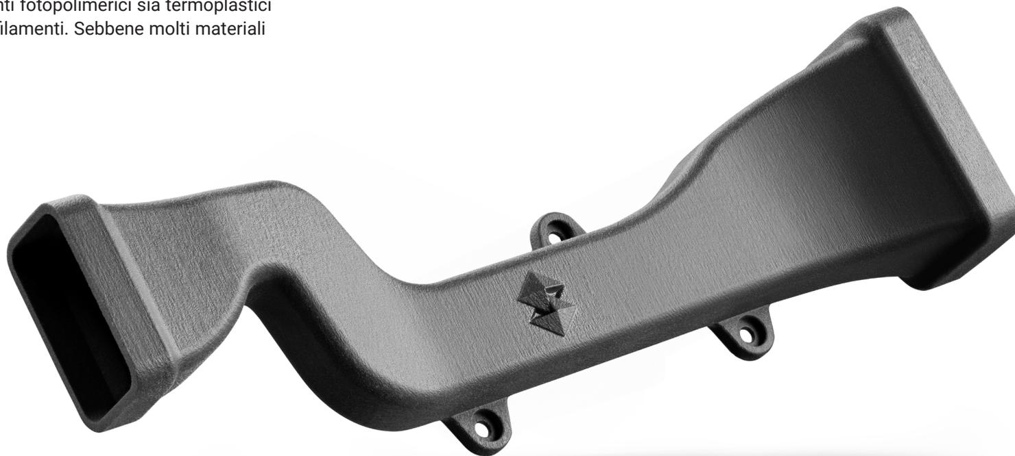
Questo condotto dell'aria fa parte di un sistema HVAC per il settore automobilistico, stampato con tecnologia SAF™. Tradizionalmente, una parte come questa potrebbe essere stampata a iniezione in due metà e assemblata. Con la tecnologia SAF, le metà possono essere prodotte come una singola parte, riducendo l'assemblaggio post-lavorazione e i punti di frattura.
