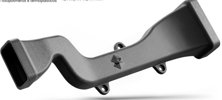
Esta seção do duto de ar de um sistema automotivo de HVAC foi impressa usando a tecnologia SAF™. Tradicionalmente, uma peça como essa pode ser moldada como duas metades e montada. Com a tecnologia SAF, as duas metades podem ser produzidas como uma única peça, o que reduz a necessidade de montagem pós-processo e os pontos de falha.
