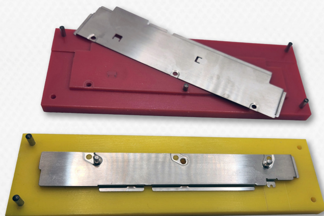
Moldes de presión para blindaje metálico de placas de circuito impreso
