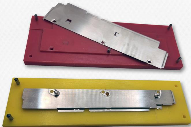
Matrices de moulage pour boîtiers de blindage de circuits imprimés en tôle
